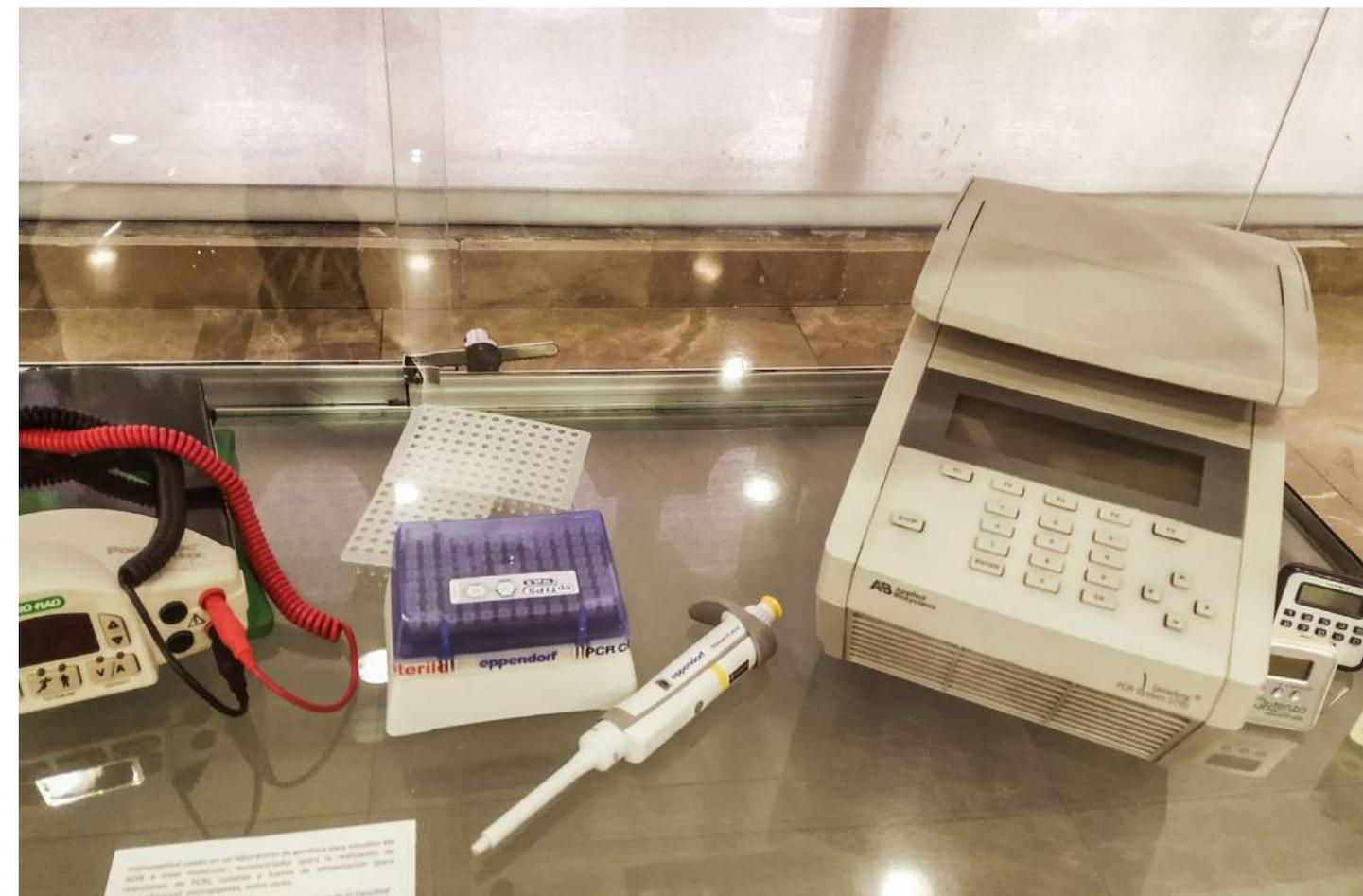
**Pieza 40.-** Instrumental usado en un laboratorio de genética para estudios del ADN a nivel molecular: termociclador (para la realización de reacciones de PCR), cubetas y fuente de alimentación (para electroforesis), micropipetas, entre otros.
