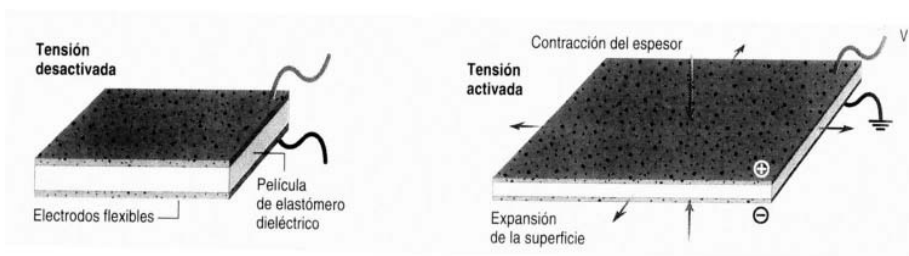
Fig. 10.—Mecanismo de músculos artificiales de elastómeros dieléctricos.
