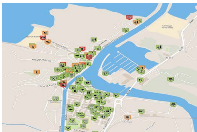
Figura 2. Ejemplo de estado de localización y accesibilidad resultante tras la introducción de datos por los alumnos en plataforma abierta OpenStreetMap, según código semafórico de Wheelmap (proyecto europeo de estudio de la accesibilidad motora). Fuente: OSM.
