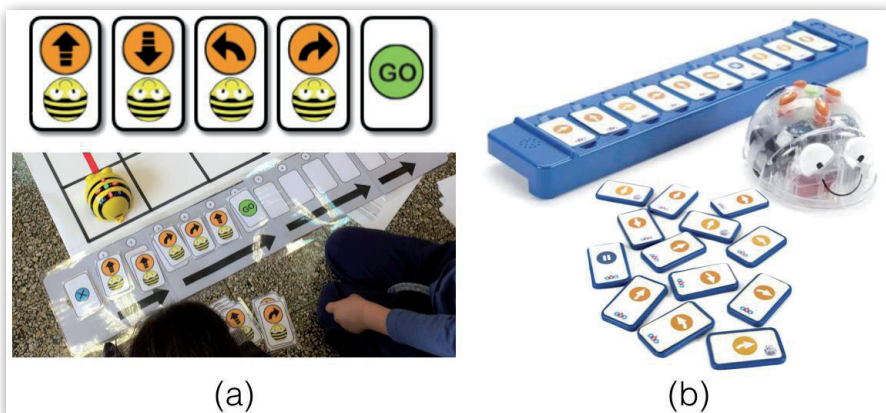
Figura 2. Bloques de instrucciones tangibles de creación propia para programar Bee-bot (izquierda) y una versión comercializada para Blue-bot (TacTile, derecha)
