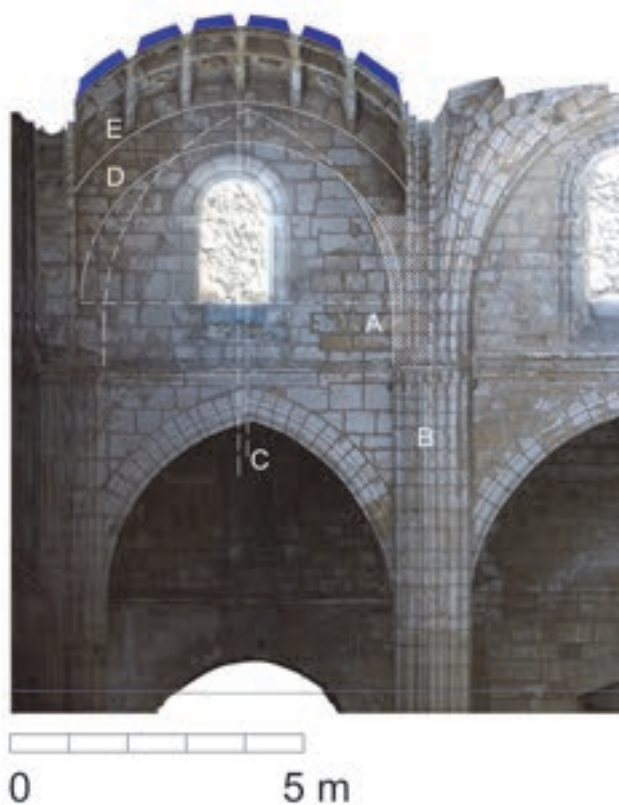
Figura 13-9. Fig. 13-9. Detalle del paramento sur del tramo cuarto con identificación de huellas. Dibujo del autor sobre ortofoto de R. Angulo
