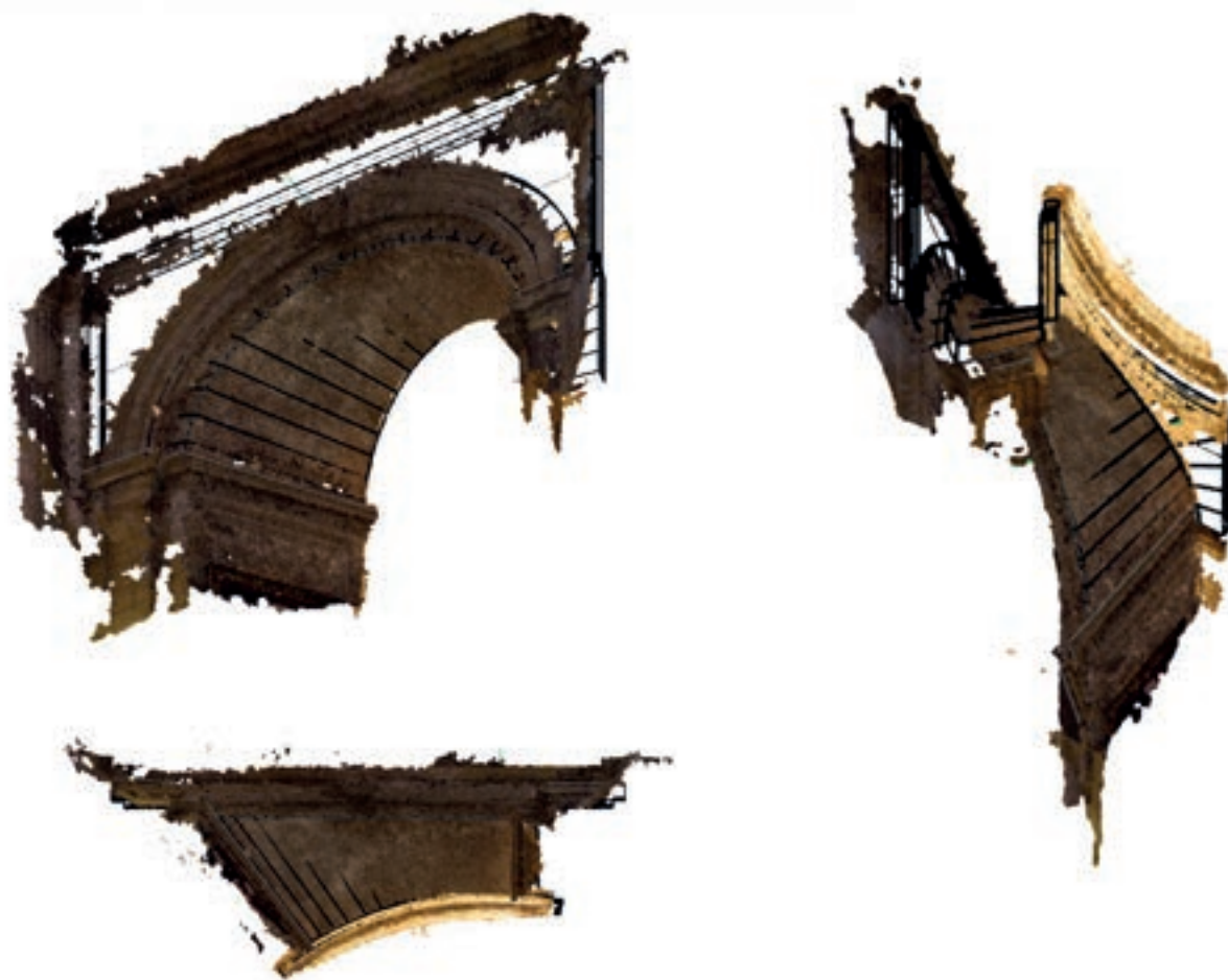
Fig. 28-3. Modelo alámbrico sobre nube de puntos obtenida con PhotoScan
