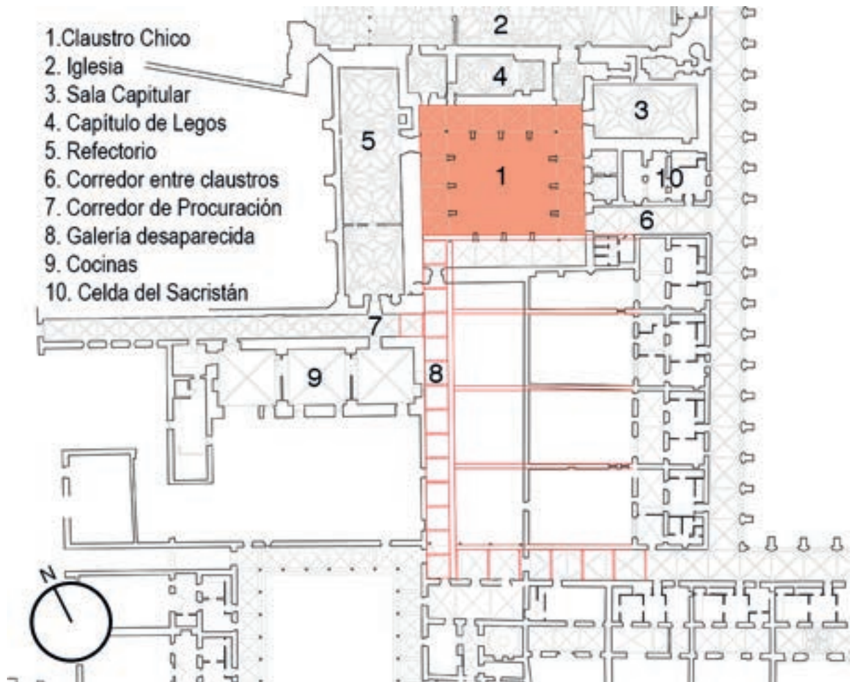
Fig. 15-3. Hipótesis de encaje de la galería norte-sur de las Cocinas entre la galería sur del Claustro Grande y el Claustro Chico rectangular. Dibujo del autor sobre la cartografía municipal
