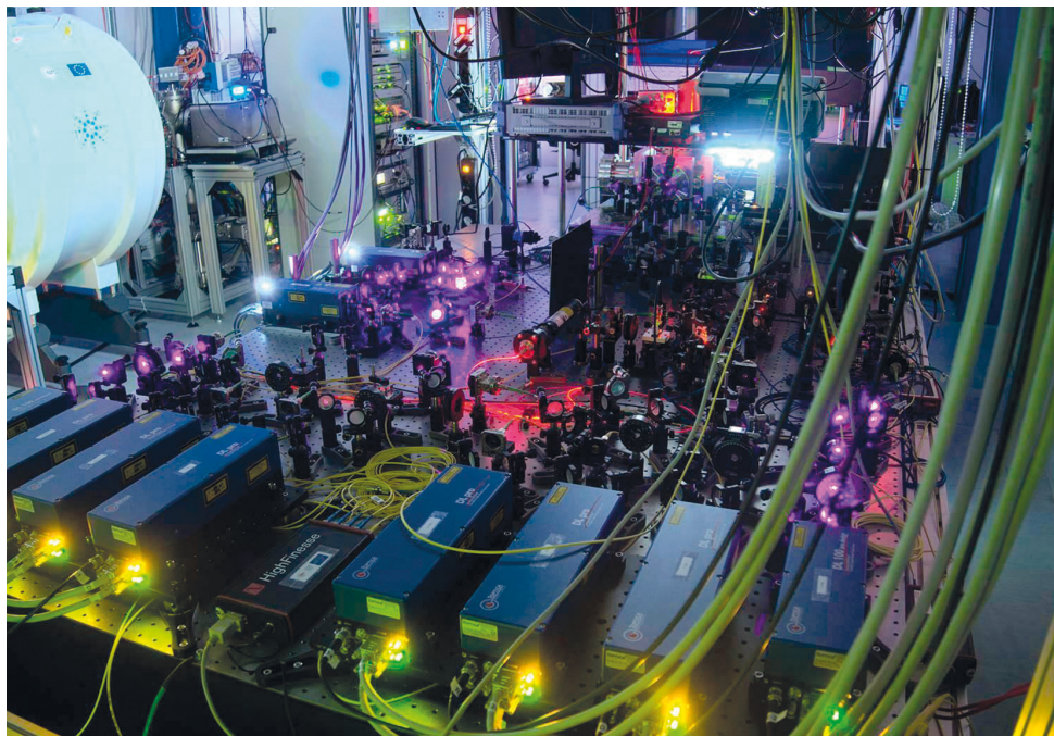
Figura 14. Mesa óptica con láseres para enfriamiento de iones del laboratorio de Trampas de Iones y Láseres. Fotografía: Maravillas García.
