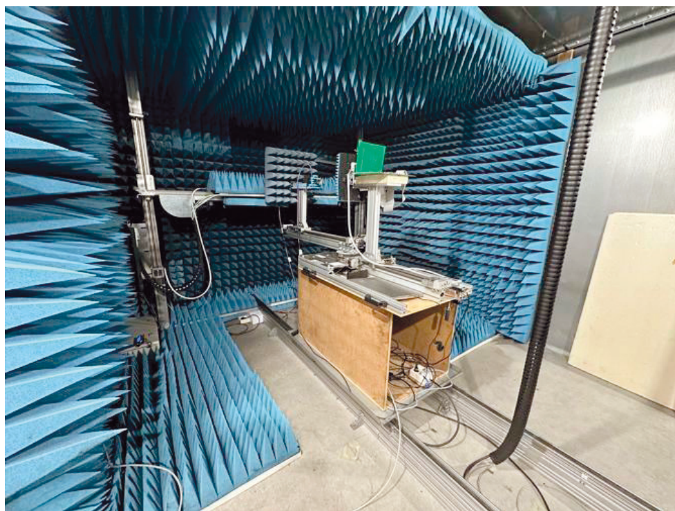
Figura 6. Interior de la cámara anecoica electromagnética del Laboratorio 5G para caracterización de antenas.
